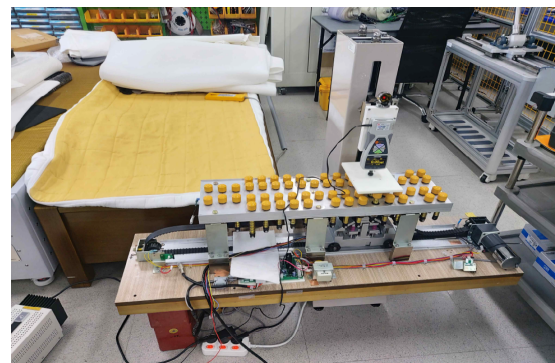
그림 13. 지압력 해상도 평가 사진 Fig. 13. Acupressure rod resolution test
