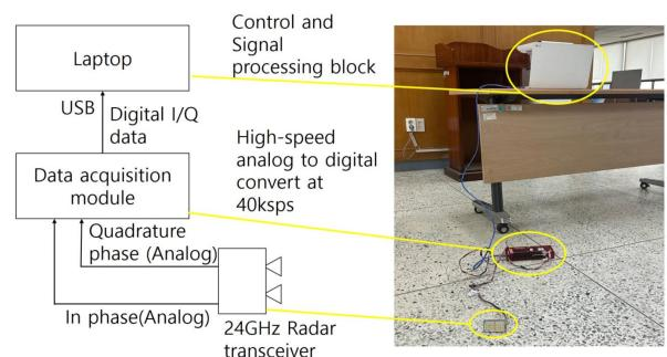
그림 1. 24GHz 레이더 측정 시스템 구성도
