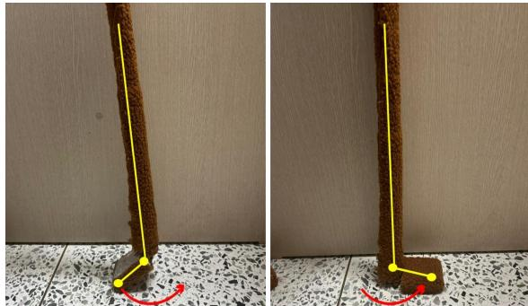
그림 2. 관절 움직임 구현을 위해 제작한 4족 보행 모사기
