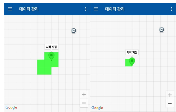
(a) 일반GPS 모드 (b) GPS-RTK 모드 (a) Stand-alone GPS mode (b) GPS-RTK mode
