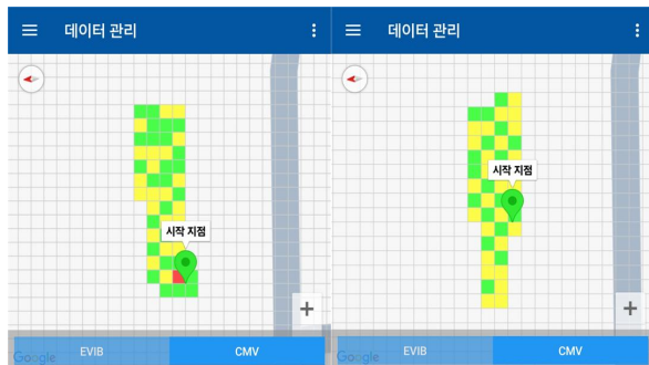
그림 7. 모의 다짐 데이터 기반 실시간 다짐맵 Fig. 7. Real-time compaction map based on simulated compaction data
