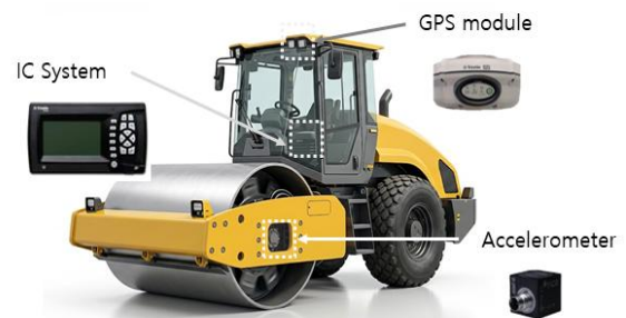
그림 1. 지능형 다짐 장비 구성 Fig. 1. Configuration of IC system
