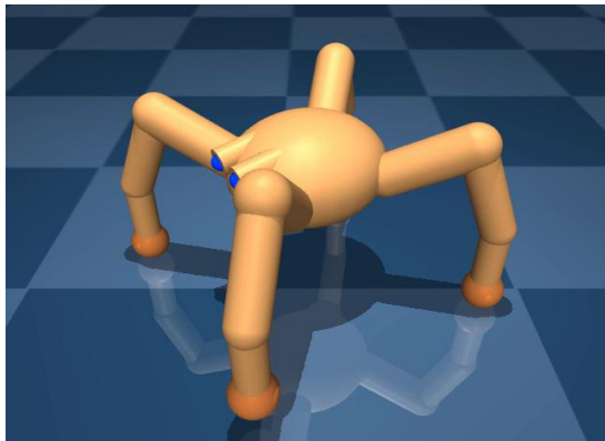
그림 4. dm_control 시뮬레이션 환경 MuJoCo 기반 4족 보행 로봇
