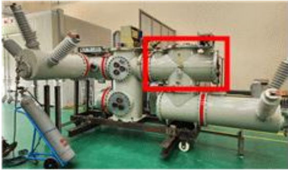
그림 1. Dry-air를 적용한 72.5 kV GIS Fig. 1. External view of the 72.5 kV Dry-air insulated GIS
