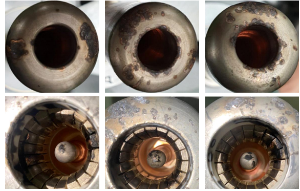
그림 7. 유도전류 개폐 시험 후 접점 상태
