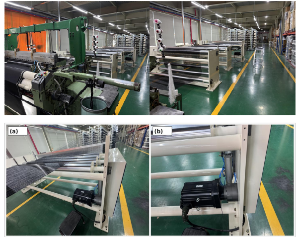
그림 2. 탄성사 크릴 장력제어 시스템 실제 사진 (a) 전체 구성 및 원사 배열, (b) 서보모터(베어링) 및 진동센서 부착 위치
