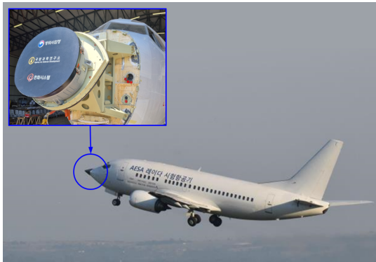
그림 3. 시험 항공기 및 레이더 형상 Fig. 3. Flying test bed and radar configuration
