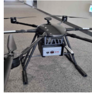
그림 9. 드론에 부착한 경량형 수신기 Fig. 9. Verification receiver attached to the drone
