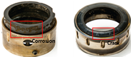
그림 2. 기계적 씰 부식과 균열 Fig. 2. Mechanical seals corrosion and crack
