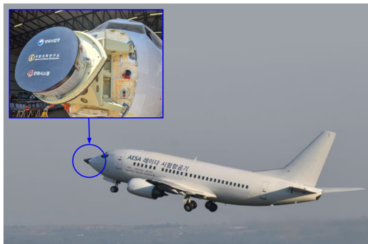
그림 4. 펄스 도플러 레이더 및 시험 항공기 Fig. 4. Pulse-doppler radar and FTB
