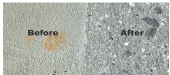
그림 3. 샷블라스트를 이용한 금속 시편 표면처리 전·후 Fig. 3. Metal surface before & after shot blasting
