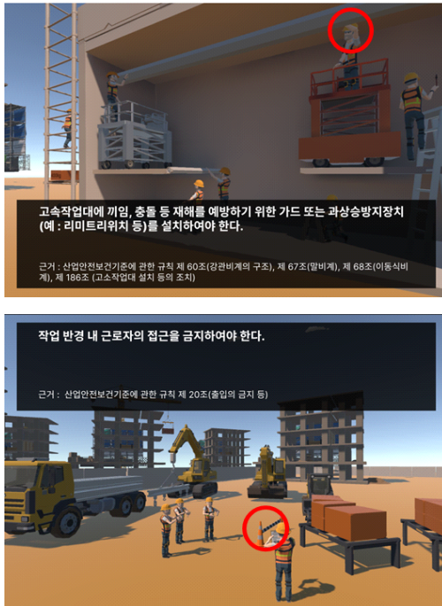
그림 9 위험 요소 식별 교육 콘텐츠 Fig. 9. Spot the hazard content
