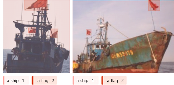
그림 7. Label-studio를 이용한 바운딩 박스 레이블링
