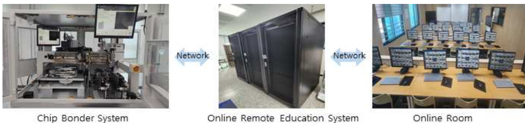
그림 2. 반도체 칩-본딩 디지털 온라인 원격 교육 플랫폼 시스템 구성도 Fig. 2. Semiconductor chip-bonding digital online remote education platform system diagram
