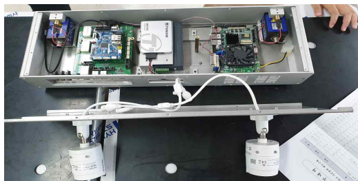
그림 3. 실제 구현된 센서장치 사진 Fig. 3. Picture of the sensor unit after implementation
