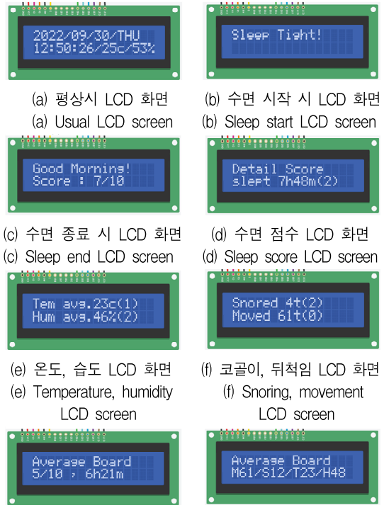
(a) 평상시 LCD 화면 (a) Usual LCD screen (b) 수면 시작 시 LCD 화면 (b) Sleep start LCD screen (c) 수면 종료 시 LCD 화면 (c) Sleep end LCD screen (d) 수면 점수 LCD 화면 (d) Sleep score LCD screen (e) 온도, 습도 LCD 화면 (e) Temperature, humidity LCD screen (f) 코골이, 뒤척임 LCD 화면 (f) Snoring, movement LCD screen (g) 평균 점수, 평균 수면시간 LCD 화면 (g) Average score, sleep duration LCD screen (h) 평균 온도, 습도, 코골이, 뒤척임 LCD 화면 (h) Average temperature, humidity, snoring, movement LCD screen
