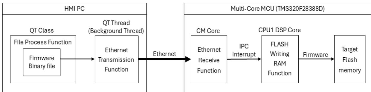
그림 1. 이더넷 기반 DSP 펌웨어 업데이트 시스템 구조
