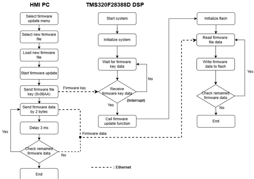
그림 3. 이더넷 기반 DSP 펌웨어 업데이트 방법의 동작 과정
