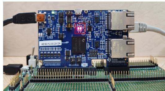
그림 9. 펌웨어 업데이트 결과 (LED 점멸)
