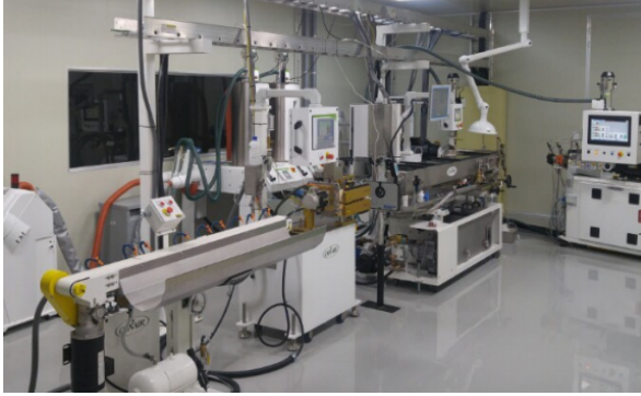
그림 4. 실제 운용 중인 압출 시스템[10] Fig. 4. In-service extrusion system[10]
