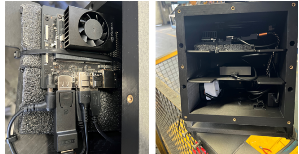
그림 10. 제작된 기구의 내부 구조 (a) 사용된 MCU, (b) 기구 내부 Fig. 10. Internal structure of the fabricated device (a) used MCU, (b) Inside the device
