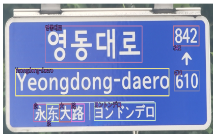
그림 4. 훈련된 모델을 활용한 다중언어 OCR 결과 Fig. 4. Multilingual OCR results using trained models
