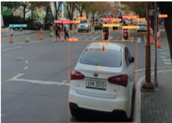
그림 4. YOLOv5를 이용한 객체 검출
