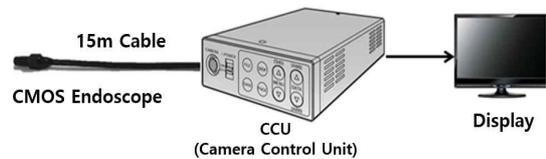
그림 8. 영상잡음 제거 모듈 탑재 초소형 내시경 시스템
