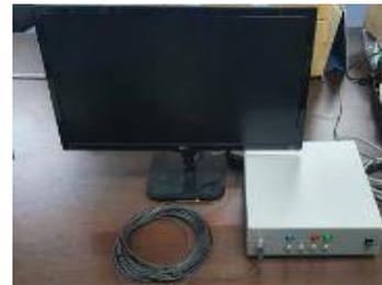
그림 9. 초소형 내시경 시스템
