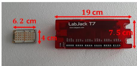
그림 5. 측정에 사용한 도플러 레이더 모듈과 DAQ 모듈
