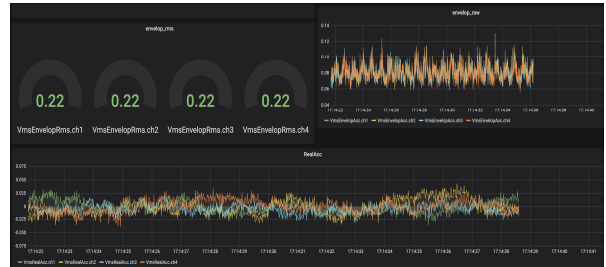
그림 4. 진동가속도 엔벨로핑 Fig. 4. Vibration acceleration enveloping
