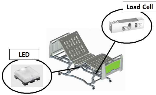
그림 3. 홈케어 침대 하부 안전등 Fig. 3. Safety light of homecare bed
