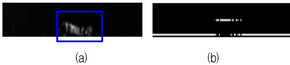
그림 11. 유리용기 내벽 균열 검출, (a) 유리용기 내벽의 균열, (b) 유리용기 내벽의 균열 검출결과 Fig. 11. Crack detection of inner wall of glass bottle, (a) Crack of inner wall of glass bottle, (b) Crack detection result of inner wall of glass bottle
