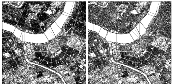
(a) 장축 길이 필터링 없음 (a) minPixels = 0 (b) 장축 길이 2픽셀 필터링 (b) minPixels = 2
