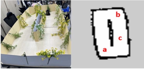
그림 8. 주행 테스트 환경 및 SLAM 경로 지점 Fig. 8. Navigation test environment and SLAM path points
