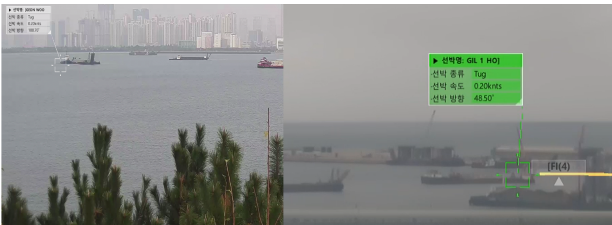
그림 12. AIS 좌표를 2차원 좌표계로 변환한 결과 Fig. 12. Results of converting AIS coordinates to 2D coordinate system
