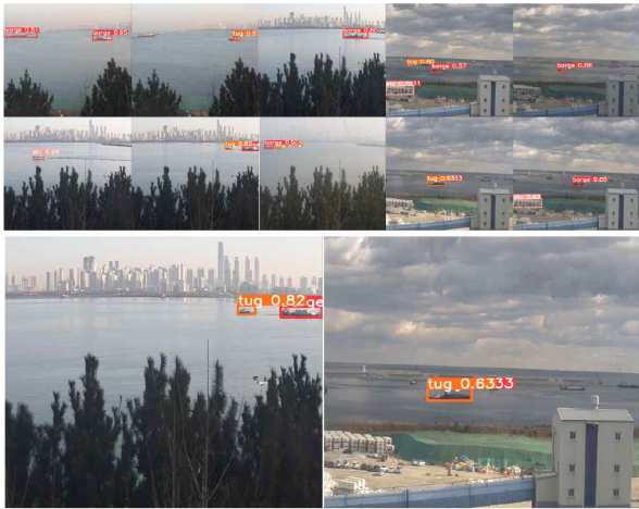
그림 7. YOLOv5를 사용한 선박 검출 결과 Fig. 7. Results of vessel detection using YOLOv5
