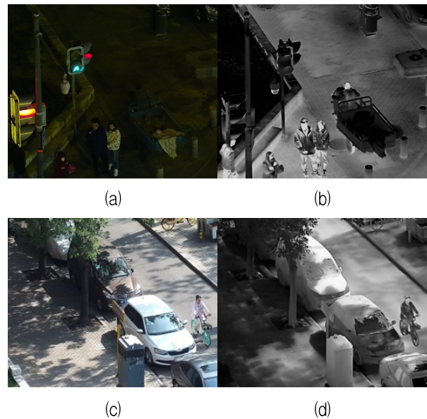
그림 1. 멀티스펙트럴 영상 예시 (a) RGB 영상(야간), (b) IR 영상(야간), (c) RGB 영상(주간), (d) IR 영상(주간) Fig. 1. Examples of multispectral images (a) RGB image(night), (b) IR image(night), (c) RGB image(day), (d) IR image(day)
