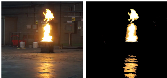
그림 3. HSV 필터 적용에 따른 모의 화재 영역 Fig. 3. Area of the simulated fire based on HSV filter application
