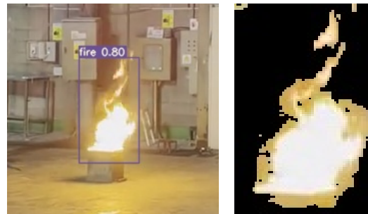
그림 6. 추론 과정과 보정 과정의 화재 검출 Fig. 6. Fire detection in the inference and correction process
