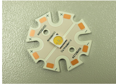
그림 5. LED 패키지 샘플 Fig. 5. LED package sample
