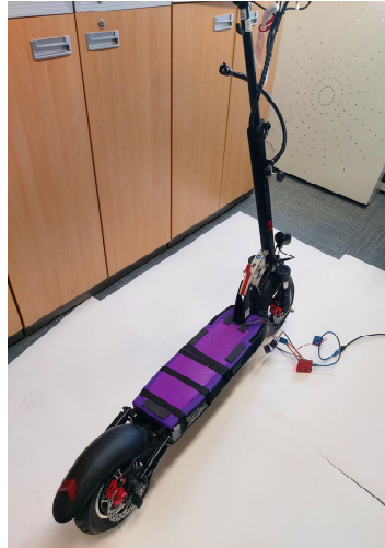
그림 3. 실험용 무게 센서의 장착 Fig. 3. Attachment of loadcells for experiments
