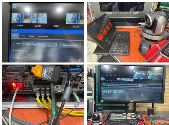
그림 7. SDI와 NDI 신호의 비교 측정을 위한 준비 및 설정 화면
