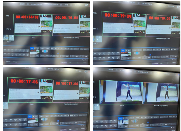
그림 8. SDI와 NDI 신호의 지연 시간 및 화면 열화 비교 측정 결과 화면
