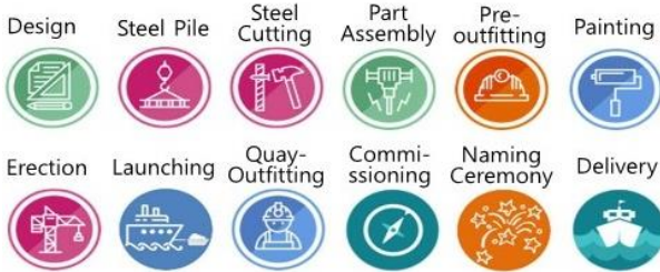
그림 2. 선박 건조 과정 Fig. 2. Ship-building processes
