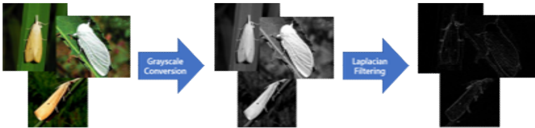
그림 3. 교사 네트워크 학습을 위한 라플라시안 필터링 기반의 에지 영상 생성 Fig. 3. Edge image generation based on laplacian filtering for teach network learning
