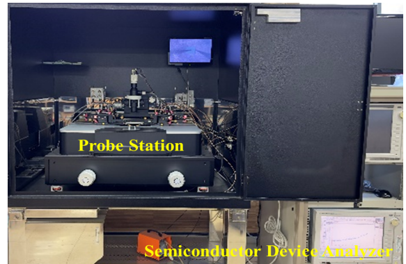
그림 5. C_T , C_J 측정 환경
