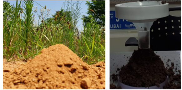
그림 4. 필드로봇시험장(좌)과 농업용로봇시험장(우)로부터 채취한 토양의 흩더미 형상
