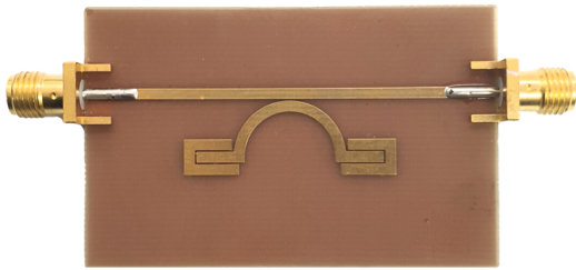
그림 6. 제작된 NGDC prototype 사진 Fig. 6. Photo of the fabricated NGDC prototype
