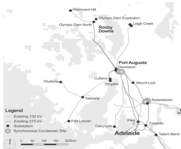
그림 5. 호주의 동기조상기 설치 사례 Fig. 5. Examples of SC installation in Australia
