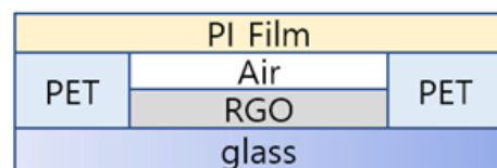
그림 1. Thermal acoustic을 이용한 RGO 패널의 구조 Fig. 1. Structure of RGO panel using thermal acoustic
