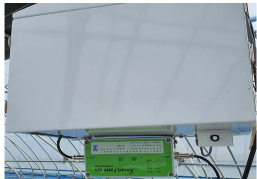
그림 8. 실내환경센서 설치된 전력선 통신 프로토콜 변환기
