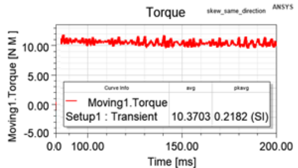
그림 5. 고정자와 회전자에 동일 방향의 스큐 각도로 제공한 조합의 토크 파형과 토크 리플 Fig. 5. Torque and its ripples in case of skews with same angle at both stator and rotor
