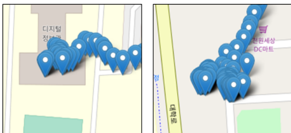
그림 2. 건물 체류 시 발생하는 잡음들 Fig. 2. Noise generated while staying in the building
