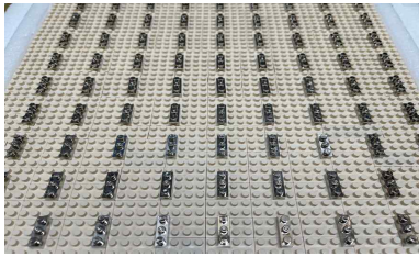
(a) 다이폴형 FSS 구조 (a) Dipole-type FSS structure
