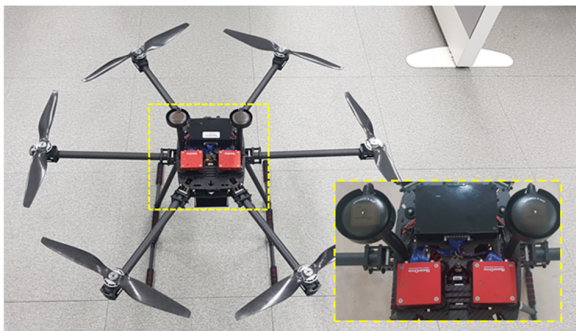
그림 8. FCC 이중화시스템의 실증 기체 탑재 모습 Fig. 8. Drone mounting the dual FCC system
