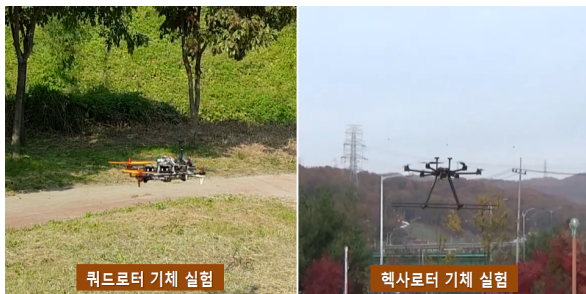
그림 9. 실증 기체를 이용한 FCC 성능 실험 Fig. 9. Experiment of the proposed dual FCC system
