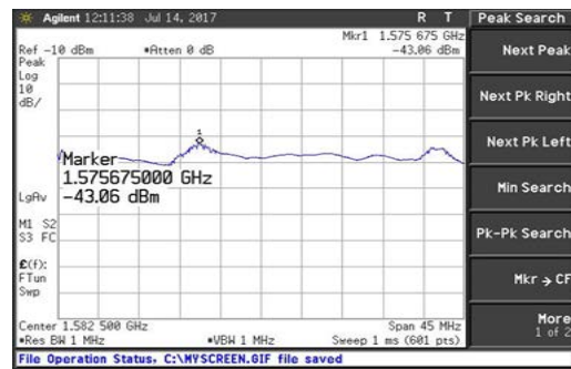
그림 14. 400m지점의 GPS대역 수신 전계강도 Fig. 14. Receiving electric field strength in GPS band at 400m point
