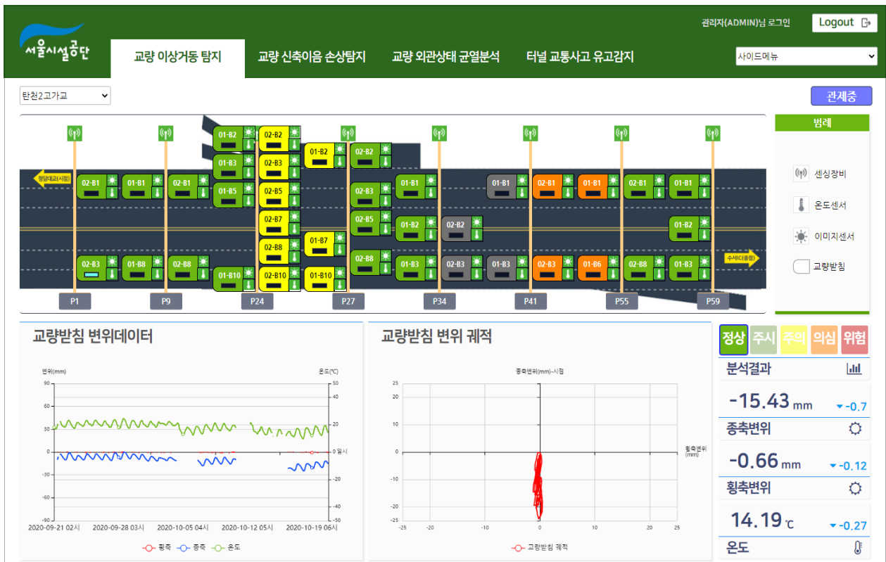
그림 4. 교량받침 마상거동 탐지 서비스 Fig. 4. Shoe(Bridge Bearing) abnormal movement sensing
