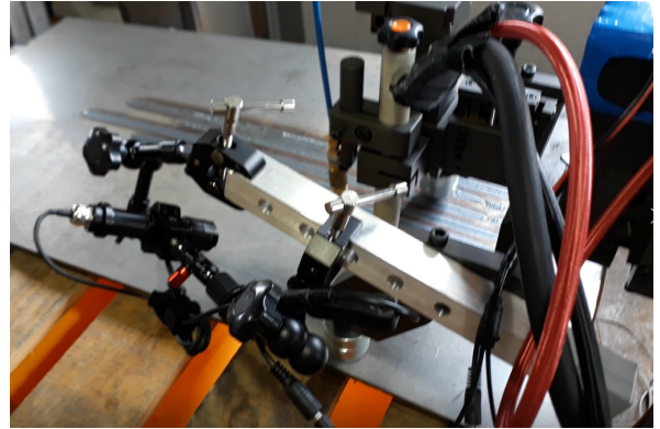
그림 7. 용접 로봇에 부착된 카메라 그림 Fig. 7. Camera illustration attached to a welding robot
