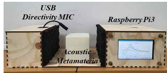
(b) 측정 환경 (b) Measurement environment 그림 2. 음향 스펙트럼 측정 시스템
